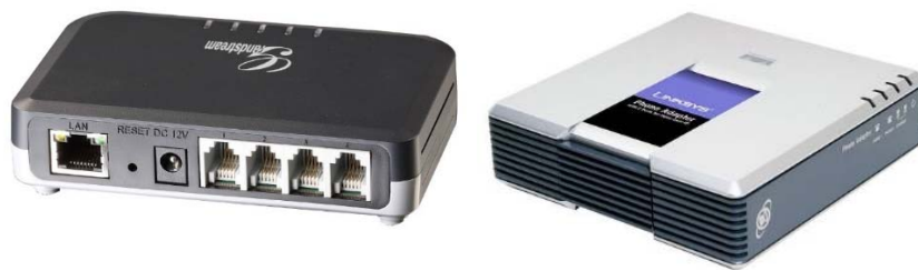
Figura 10. Adaptadores ATA Grandstream y Linksys pap2 para VoIP. Fuente: Elaboración Propia.
